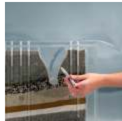
Der Grundwasserspiegel kann eingezeichnet werden.
